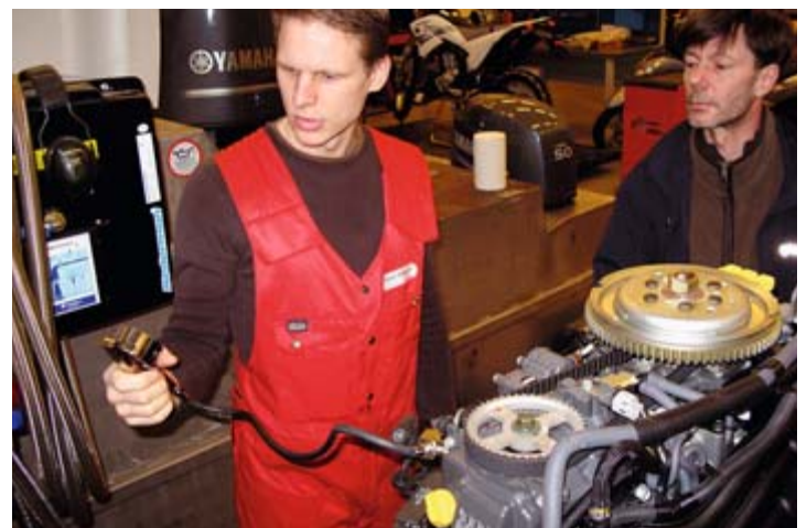
Moottorit purettiin kauden päätyttyä ja osien kuluneisuus tarkistettiin silmämääräisesti ja erilaisin mittauksin.
