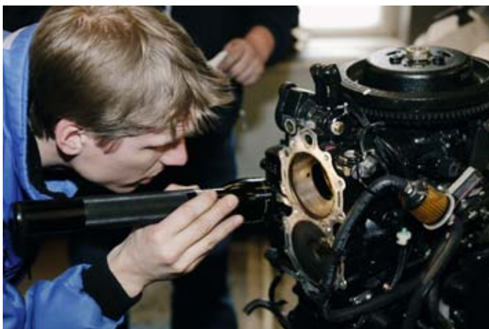
Moottorit purettiin kauden päätyttyä ja osien kuluneisuus tarkistettiin silmämääräisesti ja erilaisin mittauksin.
